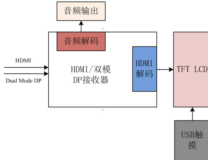
图 7-1 HDMI 系列显示屏内部架构图
