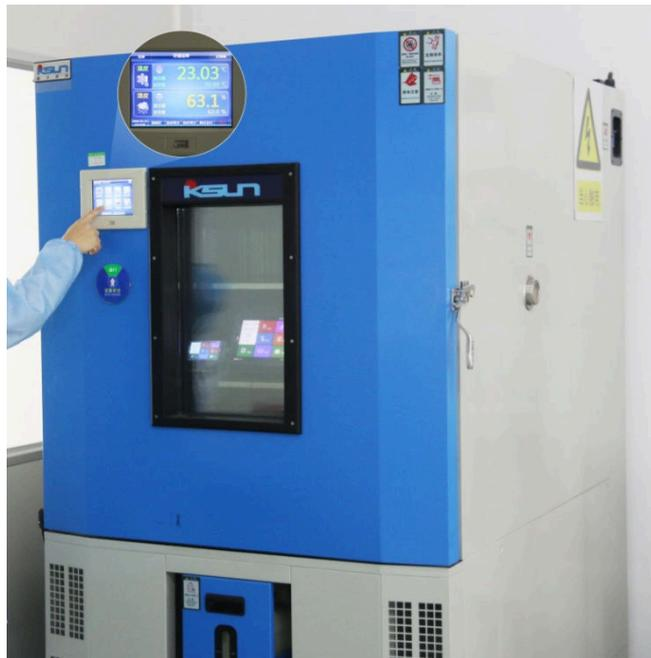
图 3-3 高低温老化测试图
